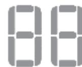
**Wyświetlacz wilgotności i zegara** – Kiedy urządzenie jest włączone, wyświetla aktualny poziom wilgotności w pomieszczeniu. Po dostosowaniu poziomu wilgotności wybrana wartość będzie migać na wyświetlaczu, a następnie wyświetlony zostanie aktualny poziom wilgotności.
