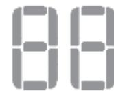
**Display Luftfeuchtigkeit und Timer** - Wenn das Gerät eingeschaltet wird, zeigt es das aktuelle Luftfeuchtigkeitsniveau im Raum an. Wenn das Luftfeuchtigkeitsniveau eingestellt wird, blinkt die gewählte Luftfeuchtigkeit kurz auf dem Display, dann wird das aktuelle Luftfeuchtigkeitsniveau angezeigt.
