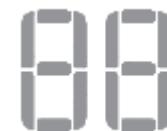
**Display for luftfuktighet og tidsur** - Når enheten slås på, viser den aktuelt luftfuktighetsnivå i rommet. Hvis luftfuktighetsnivået endres, blinker valgt luftfuktighetsnivå i displayet, deretter vises gjeldende luftfuktighetsnivå.
