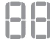
**Pantalla de humedad y temporizador** – Cuando el aparato está encendido, muestra el nivel de humedad actual en la habitación. Cuando se ajusta el nivel de humedad, la humedad seleccionada parpadeará brevemente en la pantalla y luego se mostrará el nivel de humedad actual.
