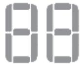
**Fuktighets- och timerdisplay** – När apparaten är påslagen visar den rummets aktuella luftfuktighetsnivå. När luftfuktighetsnivån justeras blinkar den valda luftfuktigheten kort på displayen och den aktuella fuktighetsnivån visas.
