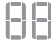
**Visualizzazione dell'umidità e del timer** - Quando l'apparecchio è acceso, visualizza il livello di umidità corrente nella stanza. In caso di regolazione del livello di umidità, l'umidità selezionata lampeggerà brevemente sul display, quindi verrà visualizzato il livello di umidità corrente.
